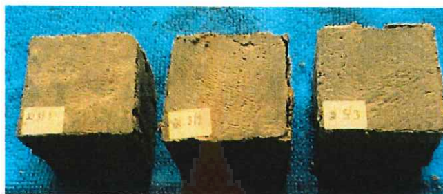
รอยแตกร้าวของก้อนตัวอย่างมอร์ต้า เมื่อได้รับแรงอัดสูงสุด (ด้านข้าง)
