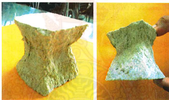
รอยแตกร้าวของก้อนตัวอย่างมอร์ต้า ลักษณะที่ถูกต้องตามการแตกร้าวของคอนกรีต รูปทรงลูกบาศก์ เป็นรูปปิรามิด เมื่อได้รับแรงอัดสูงสุด (ภายในก้อนตัวอย่าง)
