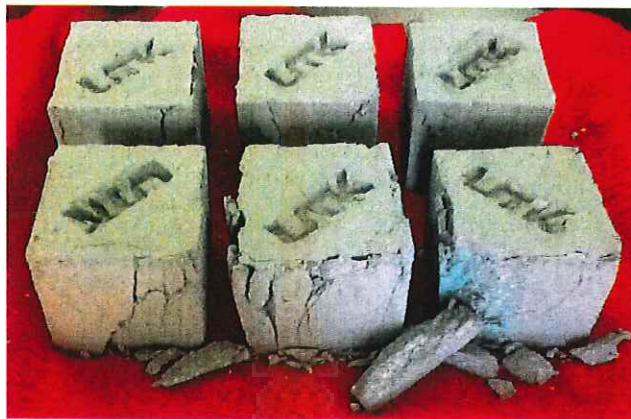
ภาพที่ 3.5 การทดสอบกำลังอัดที่อายุการบ่ม 28 วัน แบบมอร์ต้าที่มีตราสัญลักษณ์มหาวิทยาลัย UTK
