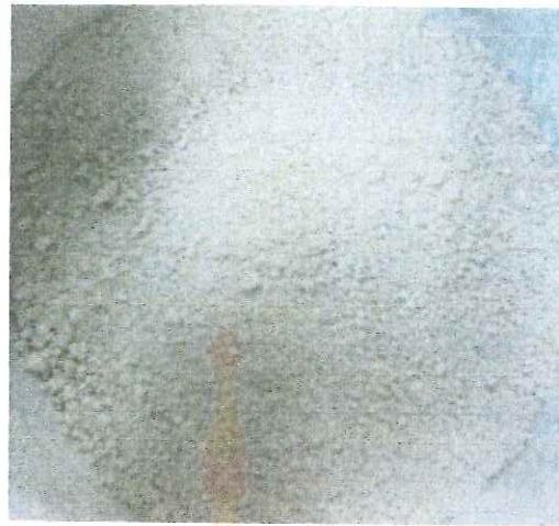
ภาพที่ 4.28 ซีโอไลต์ที่สังเคราะห์ได้จากดินขาวลำปาง
