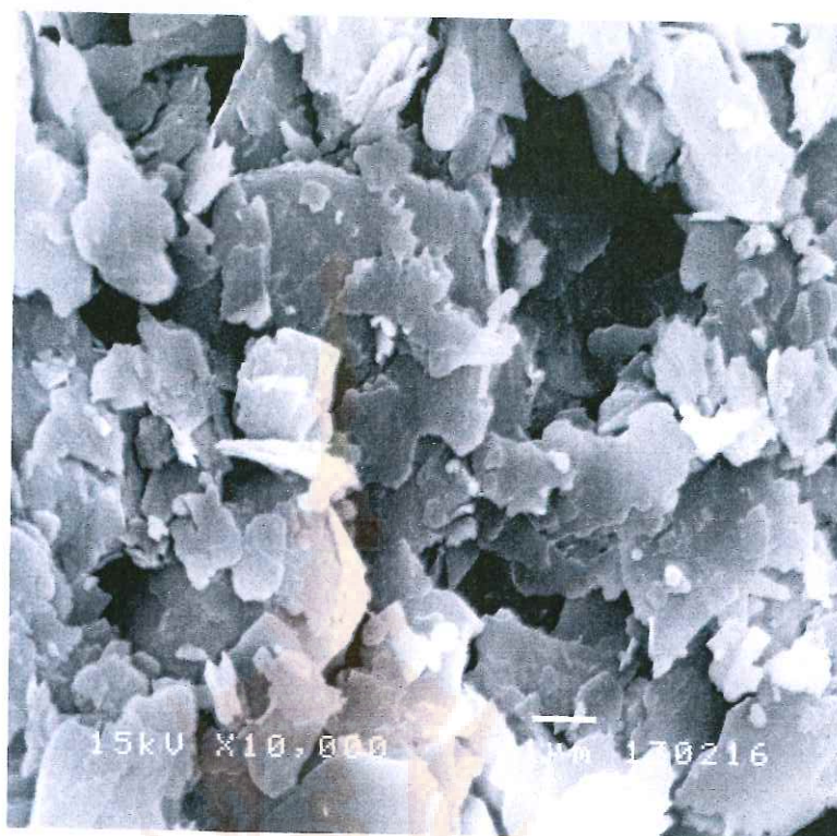
ภาพที่ 4.22 SEM of natural Lampang kaolin(x 10,000)
