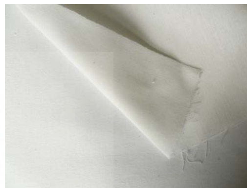
ภาพที่ 2 ผ้าฝ้าย 100 % ลายขัด 1 x 1 (ผ้าบาง)
