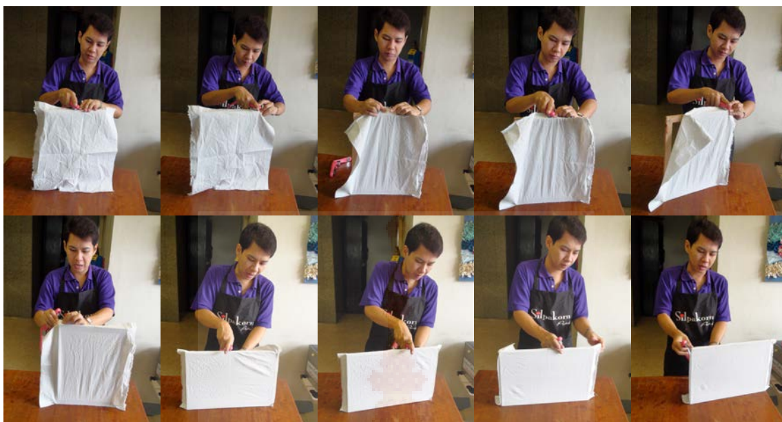
ภาพที่ 4 ขั้นตอนการจึงผ้ากับกรอบไม้
