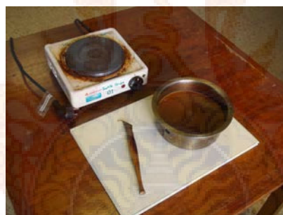
ภาพที่ 8 หม้อและเตาต้มเทียนและอุปกรณ์การเขียนเทียน
