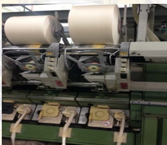
ภาพประกอบที่ 4.17 การปั่นเส้นด้ายด้วยเครื่องปั่นด้ายแบบปลายเปิด
