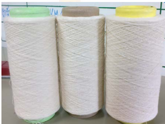
ภาพประกอบที่ 4.18 เส้นด้ายจากเส้นใยฝ้ายผสมกับเส้นใยปอสา
