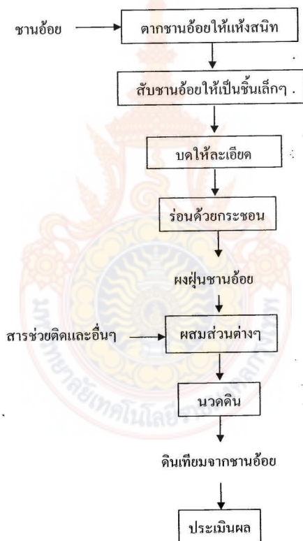
รูปที่ 3.2 ขั้นตอนการผลิตดินเทียมจากขานอ้อย
