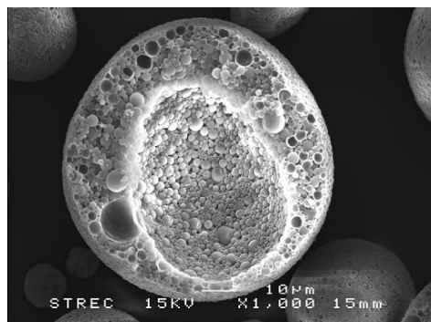
รูปที่ 2 ภาพไมโครแคปซูลเมื่อแตกจากกล้องจุลทรรศน์อิเล็กตรอนแบบส่องกราด
