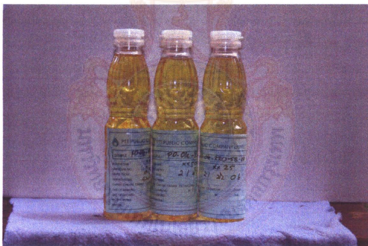
รูปที่ 4.1 ตัวอย่างน้ำมันดีเซลผสมกับน้ำมันพืชที่ใช้ในการวิจัยที่เก็บไว้เป็นเวลา 2 ปี (เริ่มบรรจุขวดวันที่ 21 มิถุนายน 2549 บันทึกภาพเมื่อวันที่ 30 มิถุนายน 2551)
