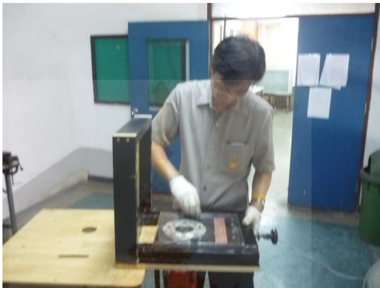
ภาพภาคผนวกที่ 5 แสดงการยึดเครื่องเร้าเตอร์กับตัวกรอบ
