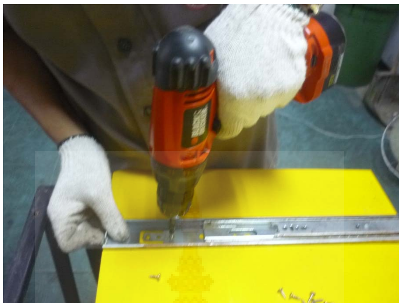
ภาพภาคผนวกที่ 13 แสดงการยึตรางเลื่อนชั้นที่ 1
