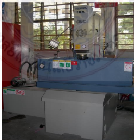
รูปที่ 3.4 เครื่องกัดเซาะโลหะด้วยกระแสไฟฟ้ายี่ห้อ Aristech รุ่น 3D-CNC EDM
