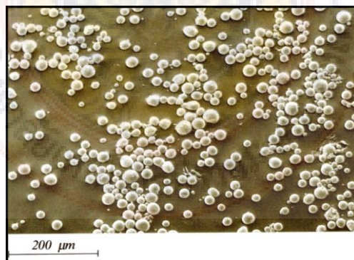
รูปที่ 2.12 อนุภาคของเศษโลหะที่หลุดออกมาด้วยสารไดอิเล็กตริก [1]
