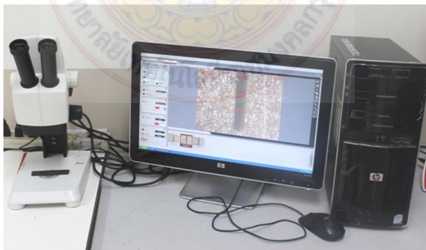
รูปที่ 3.5 การวัดความกว้างรอยตัดด้วยกล้องจุลทรรศน์
