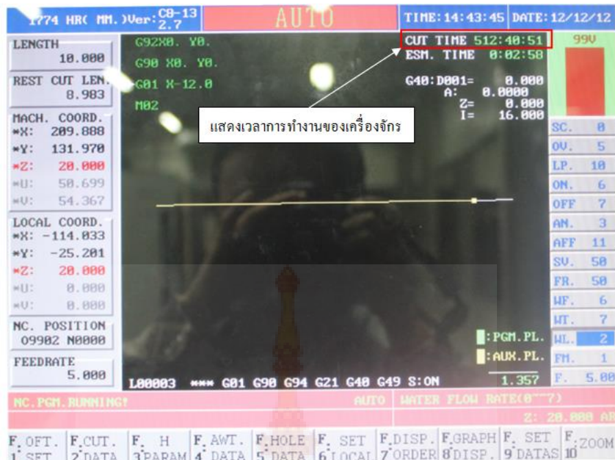
รูปที่ 3.4 หน้าจอแสดงการทำงานของเครื่องตัดโลหะด้วยไฟฟ้า ยี่ห้อ Aristech รุ่น CW30
