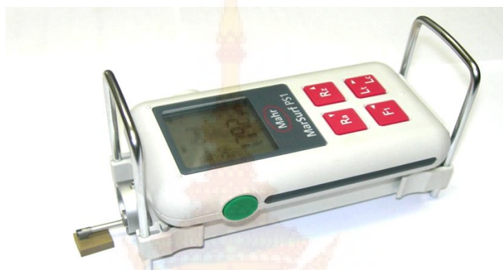
รูปที่ 3.7 เครื่องวัดความหยาบผิวยี่ห้อ Mahr รุ่น PS1
