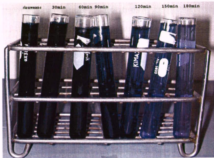
รูปที่ 4.2.4 ประสิทธิภาพการบำบัดน้ำเสียสีรีแอคทีฟด้วยขั้วไฟฟ้าเหล็ก 30 โวลต์ ที่ระยะเวลาสัมผัสต่างกัน
