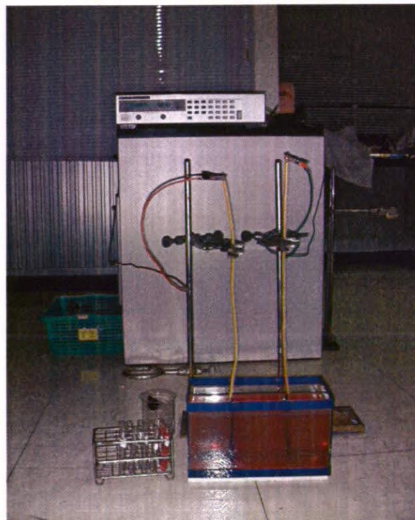
รูปที่ 3.1 ถังปฏิกรณ์ของระบบบำบัดน้ำเสียด้วยไฟฟ้าเคมี
