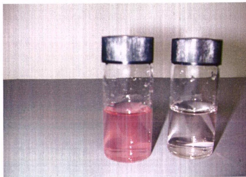
รูปที่ 4.2.11 น้ำเสียก่อนและหลังการบำบัดโดยโรงงาน
