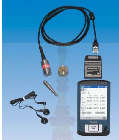
รูป 1.3 เครื่องวิเคราะห์การสั่นสะเทือนแบบพกพา SKF CMVL 3850
