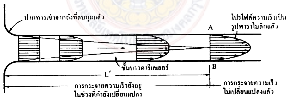
ภาพที่ 7 แสดงลักษณะการกระจายความเร็วตามแนวยาวของท่อเมื่อไหลแบบราบเรียบ
