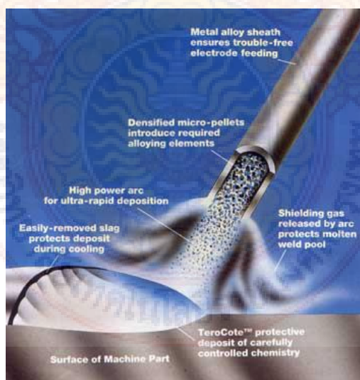
ภาพที่ 2.8 ส่วนประกอบของลวดเชื่อมไฟฟ้าหุ้มฟลักซ์
