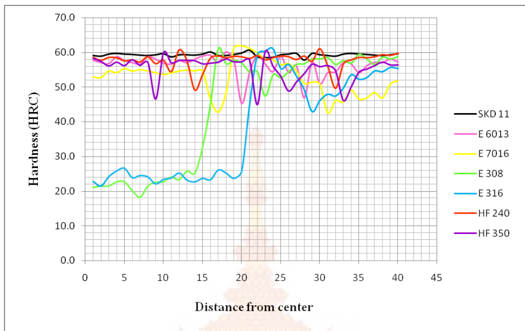
ภาพที่ 4.12 แสดงการเปรียบเทียบค่าความแข็งของวัสดุเกรด SKD 11 ที่ผ่านการเชื่อมด้วยลวดเชื่อมทั้ง 6 ชนิด หลังการอบคืนตัว(Tempering)
