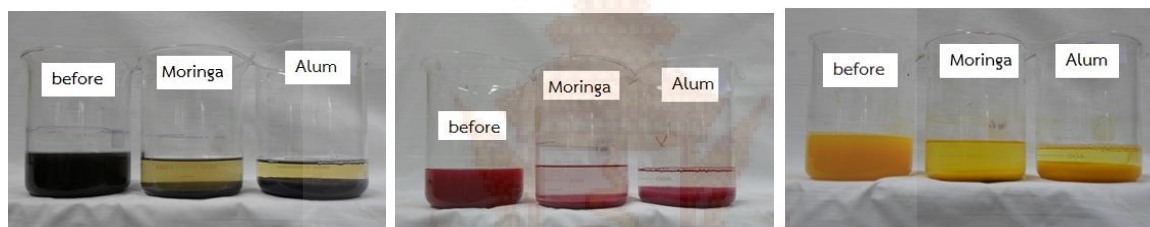
รูปที่ 4.5.4 เปรียบเทียบประสิทธิภาพการบำบัดระหว่างสารสกัดจากเมล็ดมะรุมกับอลูมิเนียมซัลเฟตในการกำจัดสีดิสเพอร์ส
