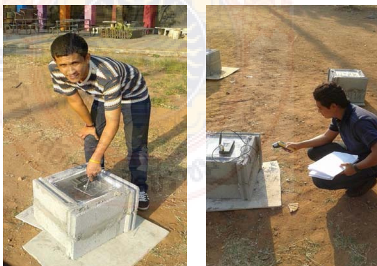
ภาพที่ 3.14 ตัวอย่างการทดสอบหาค่าความร้อนในช่วงเวลาต่างๆ
