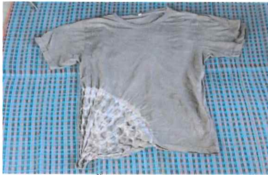
รูปที่ 4.4.2 ผ้ามัดย้อมสีสกัดจากกากกาแฟใช้น้ำปูนเป็นสารช่วยติดสี
