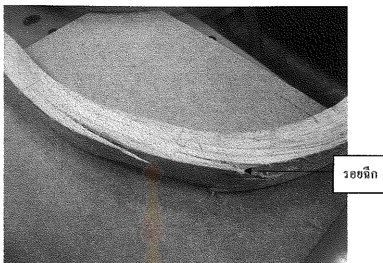
ก. 6.5 ผลการตัดโค้งไม้ยางพาราท่อนที่ 5 เกิดรอยฉีกที่ส่วนโค้งด้านนอก
