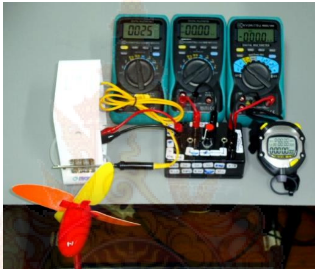
ภาพที่ 3.18 การจัดอุปกรณ์การทดลองผลของการเพิ่มการไหลเวียนของอากาศผ่านเซลล์เชื้อเพลิงต่อสมรรถนะของเซลล์เชื้อเพลิงชนิดใช้เชื้อเพลิงเอทานอล (ยังไม่เปิดพัดลม)
