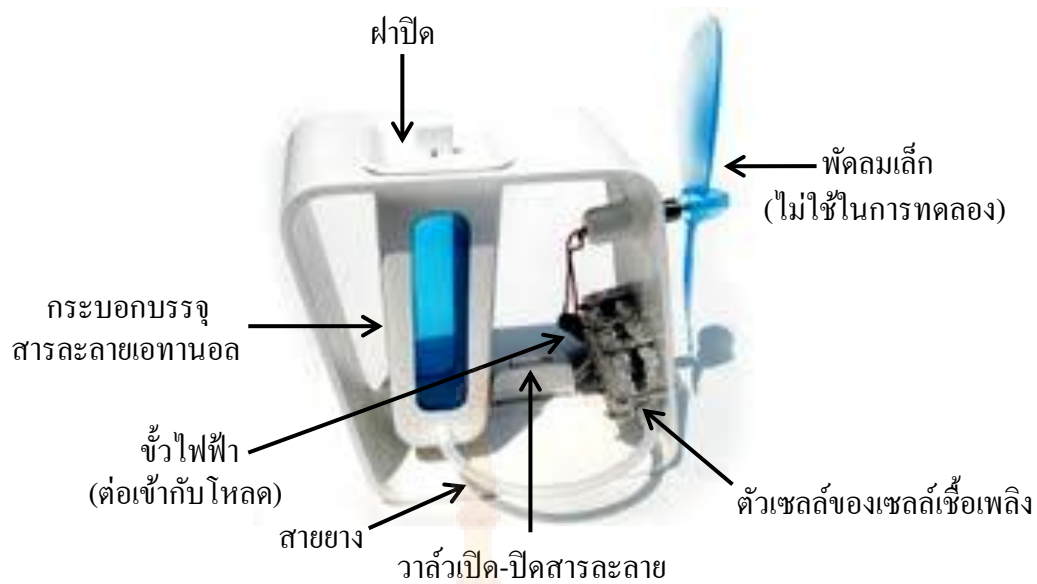
ภาพที่ 3.8 ส่วนประกอบของเซลล์เชื้อเพลิงชนิดใช้เชื้อเพลิงเอทานอลที่ใช้ในการทดลอง
