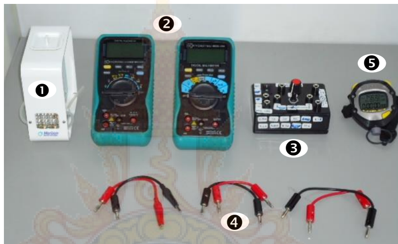
ภาพที่ 3.2 อุปกรณ์ที่ใช้ในการทดลองเพื่อทดสอบผลของความเข้มข้นของเอทานอลต่อสมรรถนะของเซลล์เชื้อเพลิงชนิดใช้เชื้อเพลิงเอทานอลโดยไม่เชื่อมต่อกับคอมพิวเตอร์
