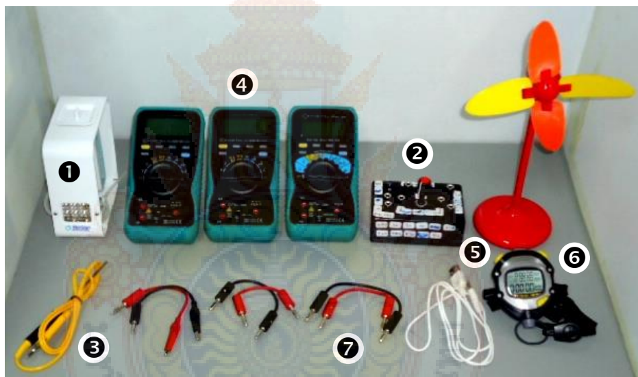
ภาพที่ 3.7 อุปกรณ์ที่ใช้ในการทดลองเพื่อทดสอบผลของการเพิ่มการไหลเวียนของอากาศผ่านเซลล์ต่อสมรรถนะของเซลล์เชื้อเพลิงชนิดใช้เชื้อเพลิงเอทานอล
