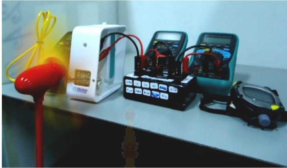
ภาพที่ 3.19 การจัดอุปกรณ์การทดลองเพื่อผลของการเพิ่มการไหลเวียนของอากาศผ่านเซลล์เชื้อเพลิงต่อสมรรถนะของเซลล์เชื้อเพลิงชนิดใช้เชื้อเพลิงเอทานอล (เปิดพัดลม)
