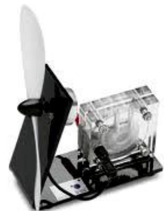
ภาพที่ 2.11 เซลล์เชื้อเพลิงชนิดใช้เชื้อเพลิงเมทานอลที่ผลิตขึ้นมาใช้งานจริง
