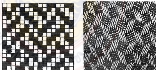
ภาพที่ 31 โครงสร้างผ้าทอลาย Pointed Twill
