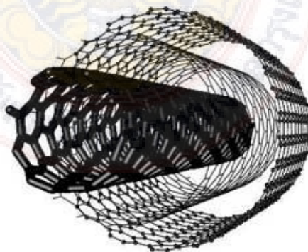
ภาพที่ 2 แสดงโครงสร้างของท่อนาโนคาร์บอนผนังหลายชั้น
