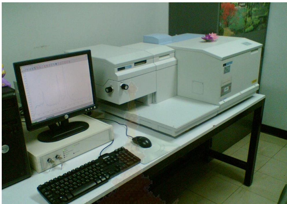
ภาพผนวกที่ 3 เครื่องฟูรีเยร์ทรานฟอร์มมามานสเปกโตรมิเตอร์ รุ่น Spectrum GX ผลิตโดยบริษัท Perkin Elmer
