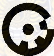
รูปที่ 3.4 จุดสัญญาณชนิดวงแหวนที่สามารถค้นหาแบบอัตโนมัติ
