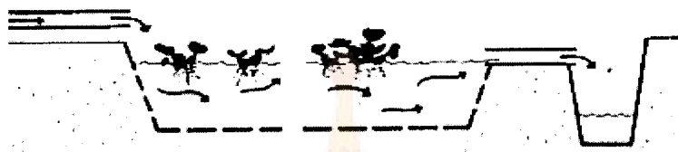
รูปที่ ๒.๒.๑ ระบบบึงประดิษฐ์ชนิดพืชลอยน้ำ
