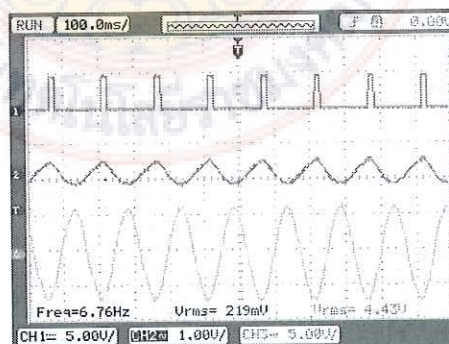
รูป 4.14 สัญญาณที่ความถี่ 6.76 Hz (ความถี่ที่ทดลองลดการสั่น 6 Hz ใช้ตัวดูดซับการสั่นสะเทือน)
