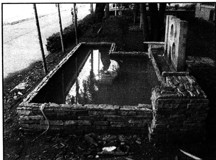
ภาพที่ ข 4 แสดงภาพบ่อเลี้ยงปลาสำหรับทดสอบเครื่องกรองน้ำสำหรับบ่อเลี้ยงปลาสวยงาม มี ขนาด กว้าง 3 เมตร ยาว 4 เมตร
