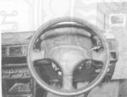
ภาพที่ 2.7 อุปกรณ์ควบคุมทิศทางและวงจรเสมือน
