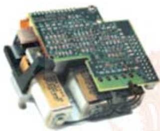
รูปที่ จ.3 อุปกรณ์ที่ใช้ควบคุมระบบความเร็วของการไหลของแก๊สใน Agilent 6890N network [22]
