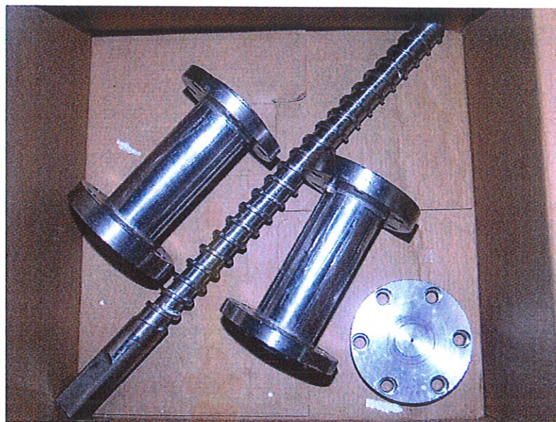
ภาพที่ 4-3 สกรูของเครื่องเอกซ์ทรูเดอร์สกรูเดี่ยวขนาดทดลอง
