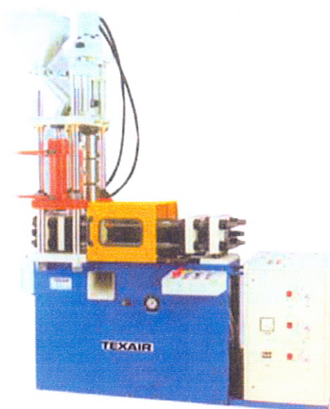
ภาพที่ 2.4 เครื่องฉีดพลาสติกแบบหัวฉีดอยู่ในแนวดิ่งพลาสติกไหลเข้าแบบในแนวดิ่งฉาก
