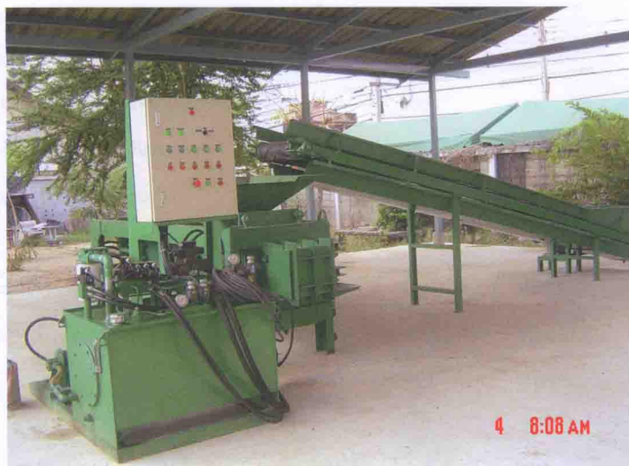
รูปที่ 4.6 เครื่องอัดขยะขนาดกำลังอัดสูงสุด 50 ตัน
